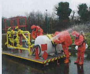
Les sapeurs-pompiers du Morbihan disposent d'une nouvelle berce de formation au risque chimique : d'un coût de 25 000 euros, elle est équipée d'un réseau de tuyauterie relié à une citerne et à une pompe délivrant une pression de 3 bars. En y injectant de
